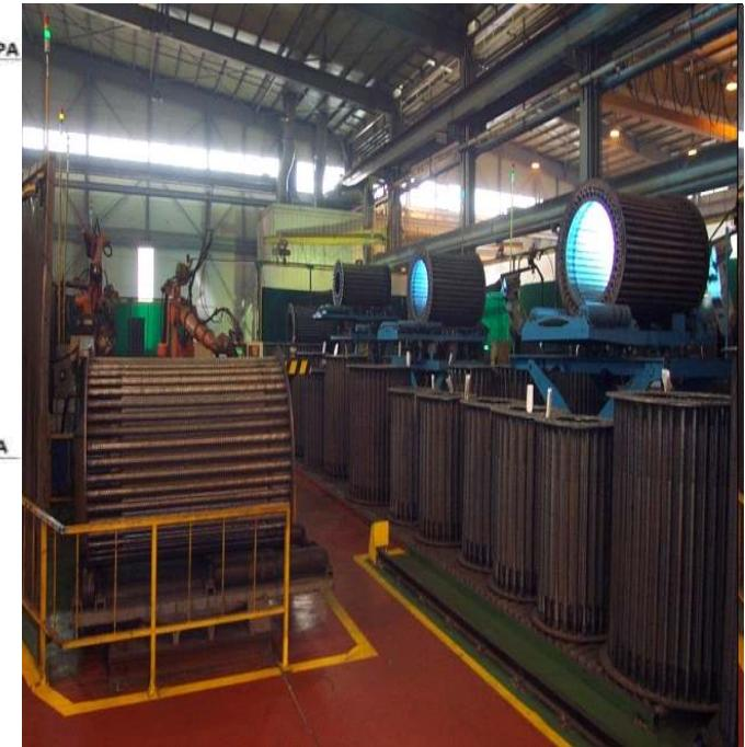
Весь модельный ряд паровых котлов представляет собой цилиндрическую конструкцию, вертикального исполнения, состоящую из двух кольцевых коллекторов соединенных трубами.
