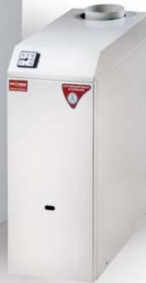
**О** топительные газовые аппараты выполнены с открытой камерой сгорания и отводом продуктов сгорания через вертикальный дымоход. Служат для теплоснабжения и горячего водоснабжения индивидуальных жилых домов, квартир, зданий коммунального назначения, оборудованных системой водяного отопления с естественной или принудительной циркуляцией.
